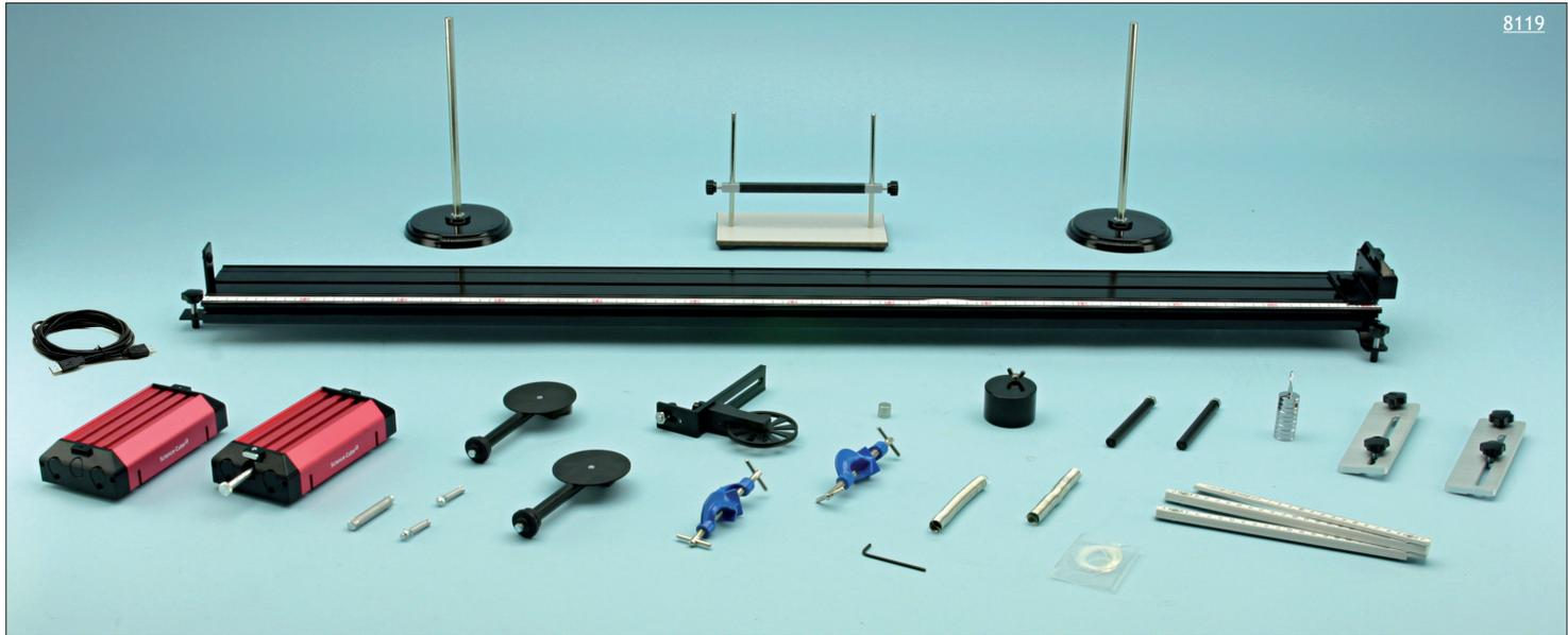
Rail en aluminium anodisé de 120 cm sur lequel circulent deux chariots avec roues montées sur coussinets à faible frottement.
