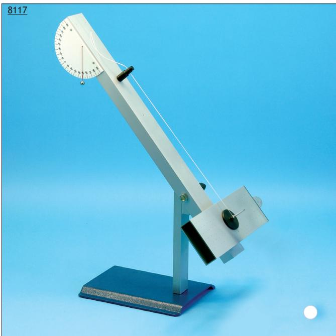
En partant de la position verticale, le pendule subit une oscillation et simultanément l'inclinaison diminue. La période augmente visiblement quand l'angle d'inclinaison par rapport à la verticale augmente.
