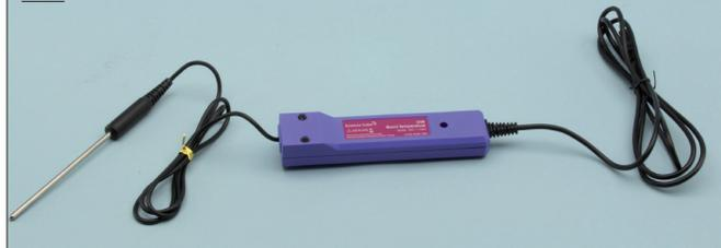
**9085** Capteur de température USB
