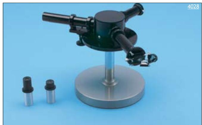
Le collimateur projette l'image de l'échelle graduée dans l'oculaire du collecteur au moyen de la réflexion sur une face du prisme. Ce dernier est un prisme équilatéral de matière hautement dispersive et il est monté sur un disque rotatif. Accompagné d'un guide didactique.
