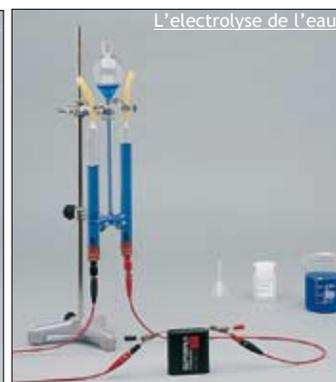
L'électrolyse de l'eau
